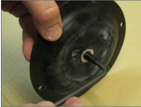
Bild 11. Schrauben Sie die Madenschraube (Teil der Kolbenstange Pos. 16) fest mit einem Imbusschlüssel in die Membrane (15).
