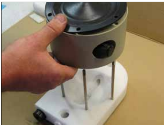
Bild 20. Setzen Sie je eine Unterlegscheibe (38) und eine Mutter (37) auf die Zuganker (14). Die Muttern sollen nur 3-4 Gewindegänge aufgeschraubt werden. Stecken Sie Zuganker durch das Gehäuse und montieren Sie den Mittelblock.
