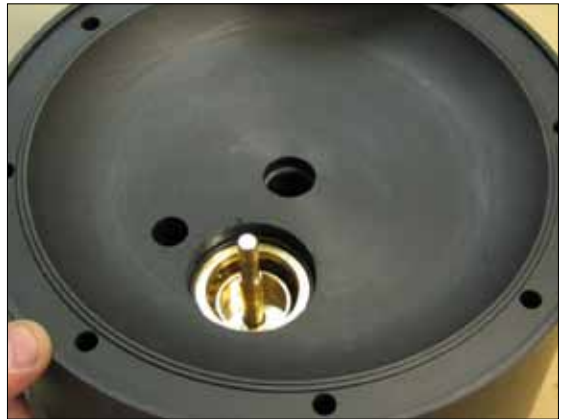
Bild 14. Nun drücken Sie die Pilotkolben und Hauptkolben aus der Ventilhülse.
