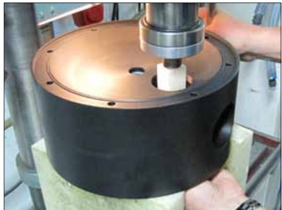
Bild 16. Drücken Sie die Hülse aus dem Mittelblock. Achten Sie darauf, die Kanten der Hülse nicht zu beschädigen.
