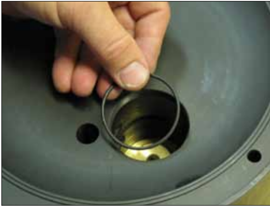
Bild 5. Setzen Sie einen der O-Ringe (30) auf die Endkappe.
