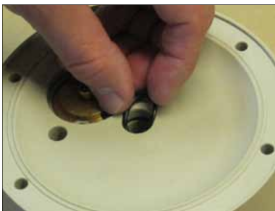
Bild 9. Setzen Sie O-Ring Mittelblockdichtung (47) in die Nut.
