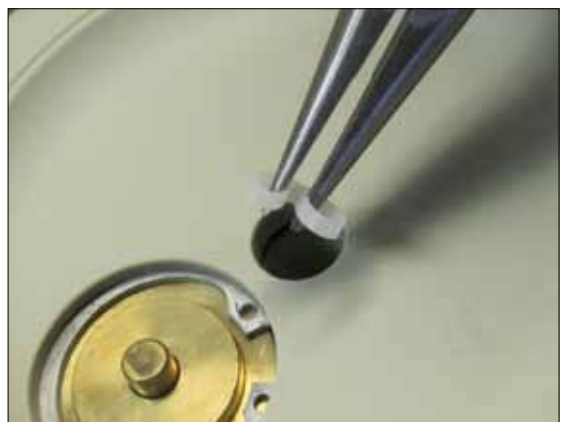
Bild 10. Um die Mittelblockdichtung (36) einzusetzen, bringen Sie diese in eine Herzform und setzen sie vorsichtig in die Nut.
