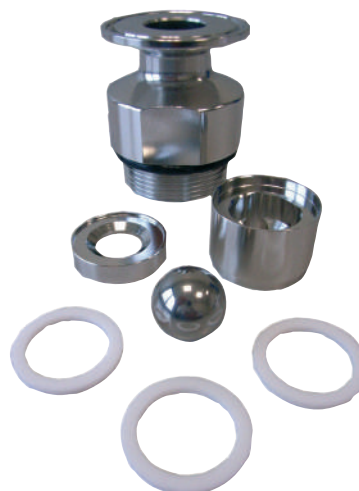
Хомутное соединение и шариковый клапан из нержавеющей стали марки SS316L с Ra < 0,8 \mu m , прокладка из PTFE (одобрен FDA)
