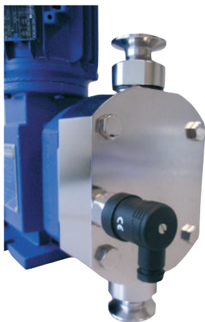
Электрополированная головка насоса с шероховатостью поверхности Ra < 0,8 \mu m с датчиком давления для системы контроля мембраны
